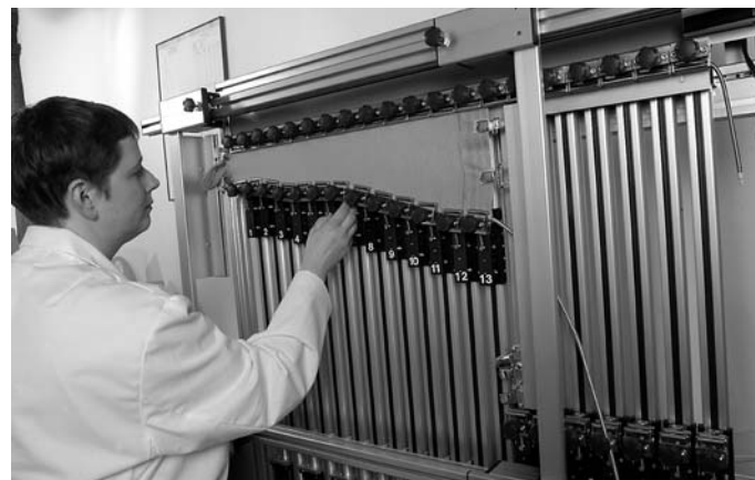
Abb. 2 Die Kompressionsmessung erfolgt mit dem Prüfgerät HOSY.
