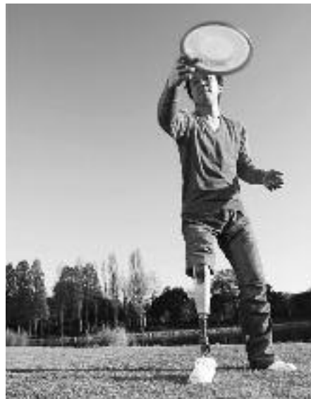
Abb. 1 Ein Beispiel für mikroprozessorgesteuerte Kniegelenke: Rheo Knee. Quelle: Össur Europe.
