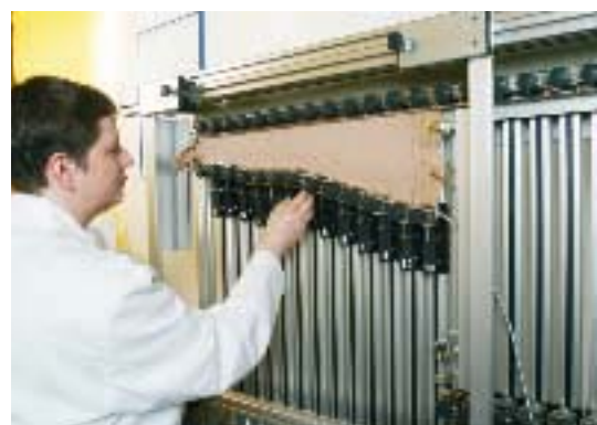
Mithilfe des Prüfgeräts „Hosy“ testet das Forschungsinstitut Hohenstein die Qualität medizinischer Kompressionsstrümpfe.
